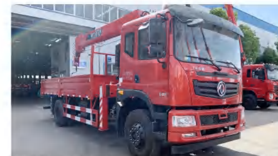
东风华神单桥8吨直臂随车吊
