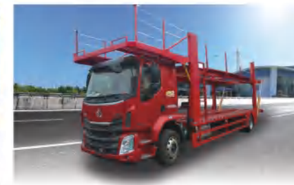
程力CLW5180TCL5型车辆运输车 额定载质量: 8270kg, 轴距: 7100mm 此车型由工程车厂生产
