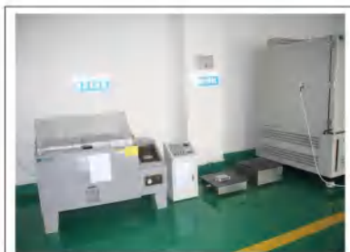
零部件盐雾实验测试平台
