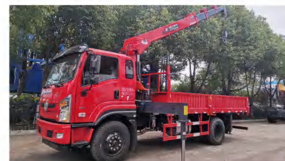
东风D1单桥6.3吨随车吊
