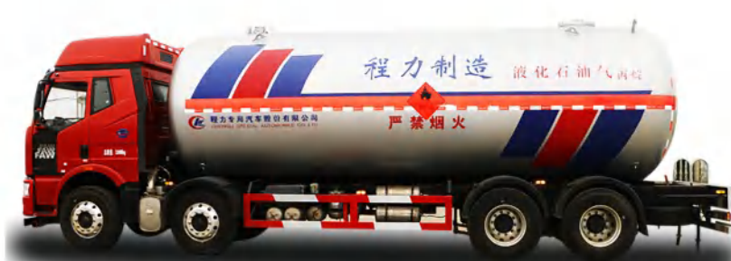
37.2立方丙烷运输车（解放8×4底盘）：装载质量为15624Kg，整备质量为16246Kg，罐体材质为Q370R。
