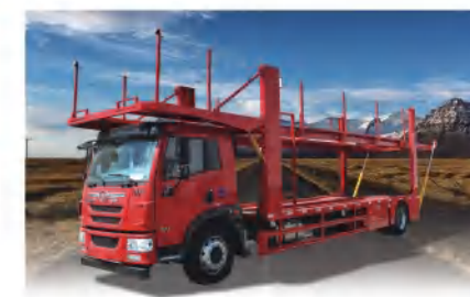
程力CLW5183TCLC5型车辆运输车 额定载质量: 8070kg, 轴距: 7200mm 此车型由工程车厂生产
