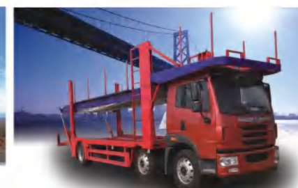
程力CLW5221TCLC5型车辆运输车 额定载质量: 8570kg, 轴距: 1950+4900mm 此车型由工程车厂生产
