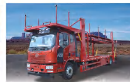
程力CLW5184TCLC5型车辆运输车 额定载质量: 8070kg, 轴距: 7100mm 此车型由工程车厂生产
