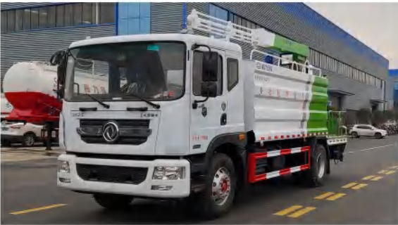
东风D9铁路抑尘车
